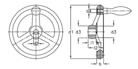
b = 26 d1 = 250 d2 H7 = 22 d3 = 45 d4 = M 12 Handle  $\overline{\phantom{a}}$  = 32 l1 = 28 l2 = 50
